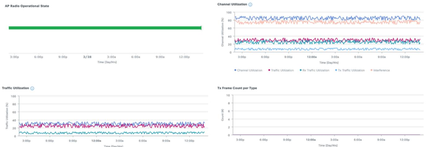
例如，如果通道利用率為80%，這意味著有「某人」通過通道傳輸的時間為80%。如果AP顯示40%的Rx利用率和40%的Tx利用率，您知道只有此AP負責保持通道忙碌（即沒有其它AP在傳輸），並且它在接收和傳輸之間處於良好的平衡狀態。如果AP組合的Rx和Tx使用率遠遠低於通道使用率，則意味著另一個AP（欺詐或受管）正在使用相同的通道並導致同通道干擾。
