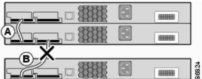
單個位置的電纜發生故障，已對堆疊進行分割槽
