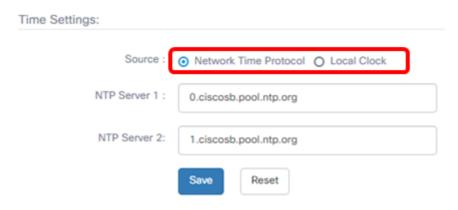
步驟13.在NTP伺服器1欄位中,輸入要與探測功能同步的主NTP伺服器地址。
