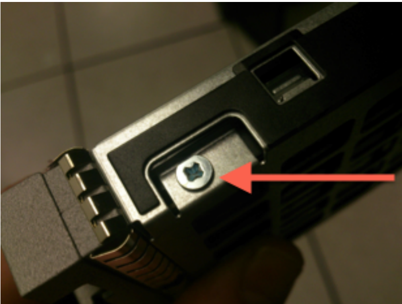
圖：四個十字頭螺釘將驅動器固定到滑板：兩邊各兩個。
