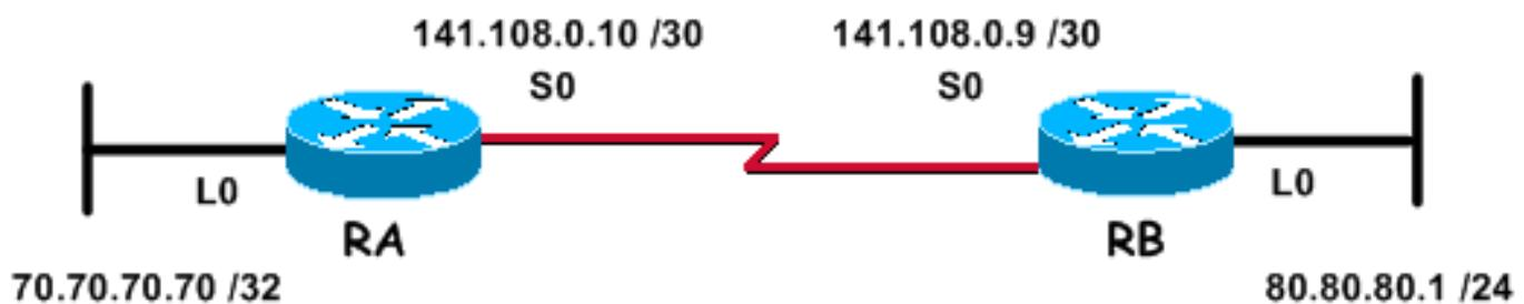
用於以下配置示例的上述網路包含兩台路由器；路由器RA和路由器RB，它們都運行RIP並定期交換路由更新。必須通過串列鏈路驗證路由資訊的交換。
