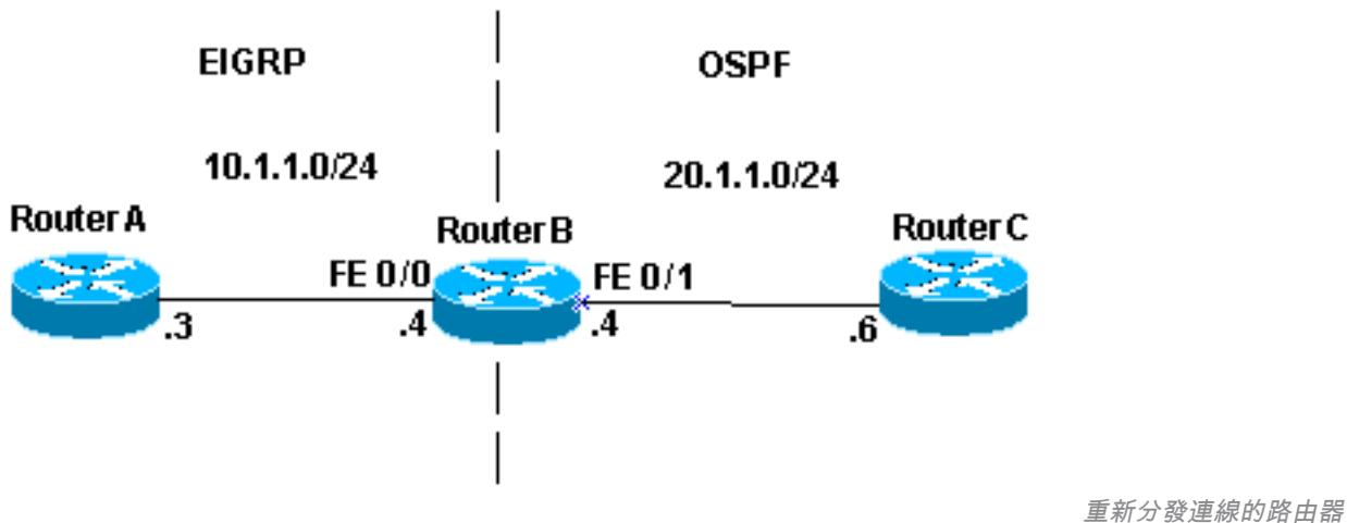
在圖例中，路由器B有兩個快速乙太網介面。FastEthernet 0/0位於網路10.1.1.0/24中，FastEthernet 0/1位於網路10.1.10.0/24中。路由器B通過路由器A運行EIGRP，通過路由器C運行OSPF。路由器B在EIGRP和OSPF進程之間相互重分佈。以下是路由器B的組態資訊：
