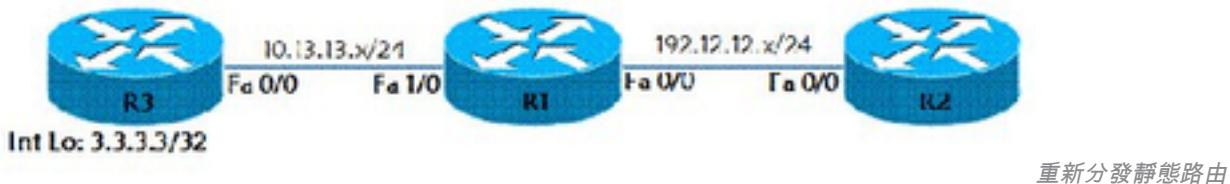
此示例說明如何將靜態路由重分配到RIP路由協定中。根據拓撲示例，我們有三台路由器（R1、R2和R3）。R1和R2在介面FastEthernet 0/0上配置了RIP。R1有一條到達路由器R3的Lo 0介面（IP地址10.10.10.10/32）的靜態路由。此靜態路由在RIP路由協定中重新分配。路由器R3配置了預設路由R3# ip route 0.0.0.0 0.0.0.0 FastEthernet 0/0。
