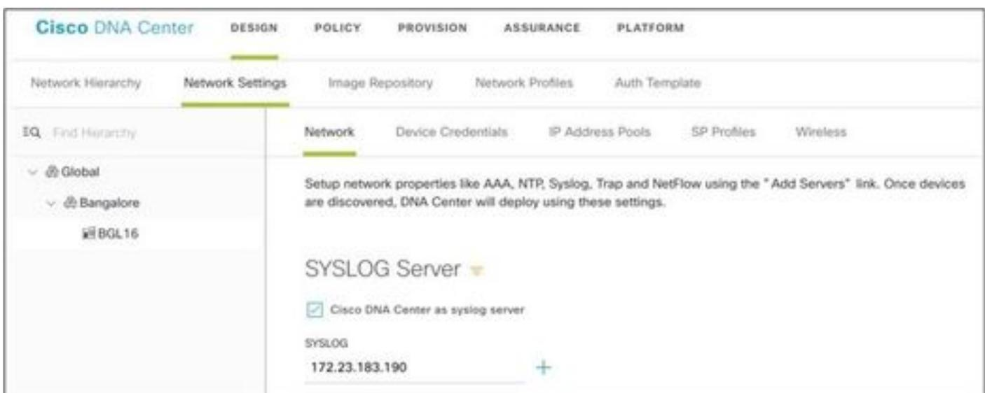
2.x版：導覽至Design > Network Settings > Telemetry > Syslogs，如下圖所示。
