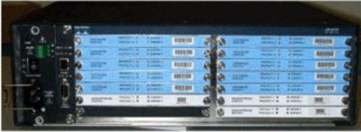
3x10 RF交換機中安裝了十個US (顯示為藍色) 和三個DS (顯示為灰色) 模組。左下角稱為模組 N，為空。前面從右上角開始的模組編號為1-13，並且與埠A-M相關聯。上游模組1在插槽1至8中具有埠A的所有中繼，在後面具有保護1和2。模組2位於左側，並且插槽1至8中的埠H的所有中繼均受保護1和2。
