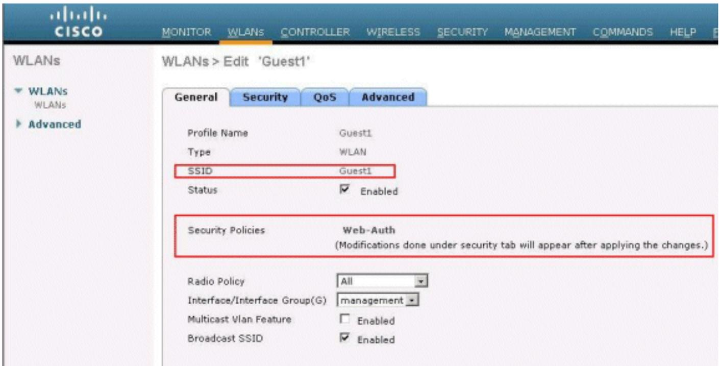
假设您有内部DHCP服务器，客户端将连接到WLAN Guest1并获取IP地址。当客户端尝试访问URL(例如，www.cisco.com)时，由于客户端浏览器上启用了手动代理，因此使用Web身份验证代理功能的控制器以网页进行响应，提示用户更改Internet代理设置以自动检测代理设置。
