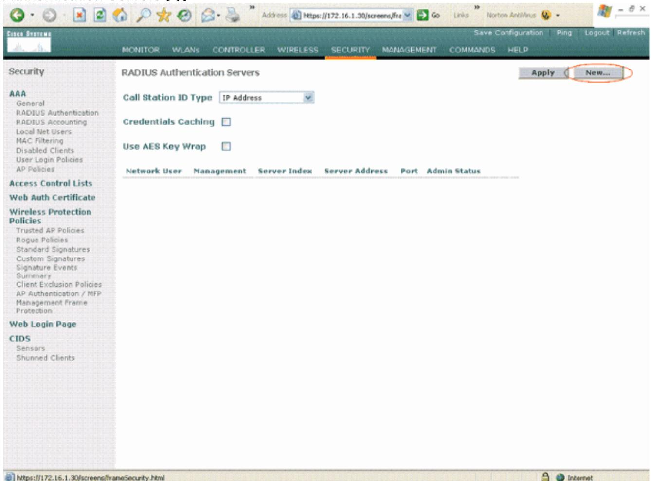
单击 **New** 以定义 **RADIUS 服务器参数**。这些参数包括 RADIUS 服务器的 IP 地址、共享密钥、端口号和服务器状态。“网络用户”和“管理”复选框决定基于 RADIUS 的身份验证是否适用于管理和网络用户。本例使用 Cisco 安全 ACS 作为 RADIUS 服务器，其 IP 地址为 172.16.1.60。
