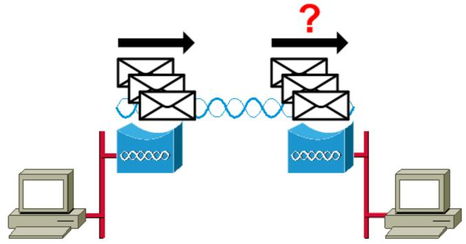
如果网桥A的传输计数高于网桥B的接收计数,则无线链路上的数据包会丢失。这种损失可能是由以下问题之一造成的:信号不够强,数据包无法到达远端。数据包被一些外部干扰破坏。如果网桥B的接收计数高于网桥A的发送计数,则接收附加信号。网桥将其解释为数据包。这种干扰可能是由以下问题之一引起的:附近的2.4 GHz设备(例如2.4 GHz无绳电话)以相同频率传输。附近一个泄漏的微波炉以相同的频率发送信号。
