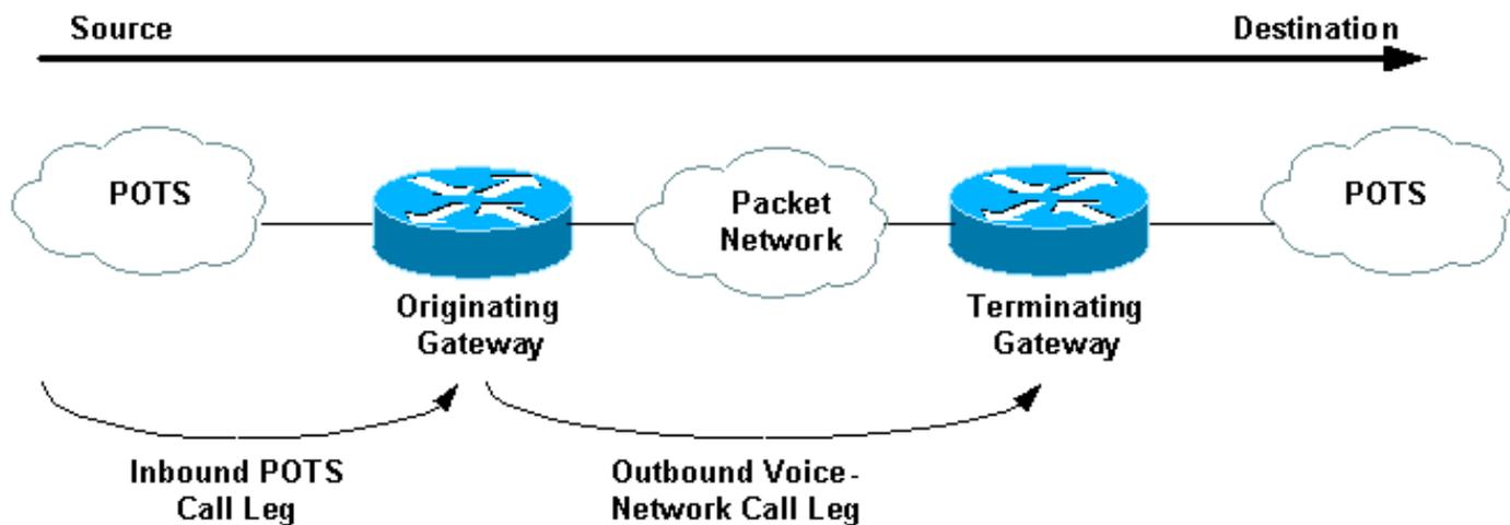
对于从简单旧式电话业务 ( POTS ) 接口发往分组网的呼入而言，发端路由器/网关首先会为呼入段匹配一个呼入POTS拨号对端。接下来，始发路由器/网关将会创建出站语音网络拨号对等体，例如为出站呼叫段创建 IP 语音 (VoIP) 或帧中继语音 (VoFR)。然后，路由器/网关将在两个呼叫段之间建立桥接。
