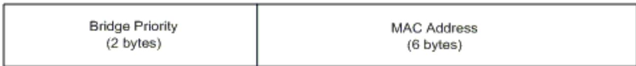
扩展系统 ID 修改网桥协议数据单元 (BPDU) 的生成树协议 (STP) 网桥标识符部分。原始的 2 字节优先级字段拆分成 2 个字段；4 位网桥优先级字段和允许 VLAN 编号范围为 0-4095 的 12 位系统 ID 扩展。
