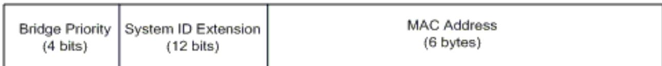
当在 Catalyst 交换机上启用扩展系统 ID 以有效利用扩展范围 VLAN 时，需要在同一个 STP 域内的所有交换机上启用该功能。为了保持 STP 根计算在所有交换机上一致，这是必需的设置。启用扩展系统 ID 后，根网桥优先级就变为 4096 的倍数与 VLAN ID 之和。因为没有扩展系统 ID 的交换机对其网桥 ID 的选择更加精细，所以这些交换机可能会在无意中声明根。
