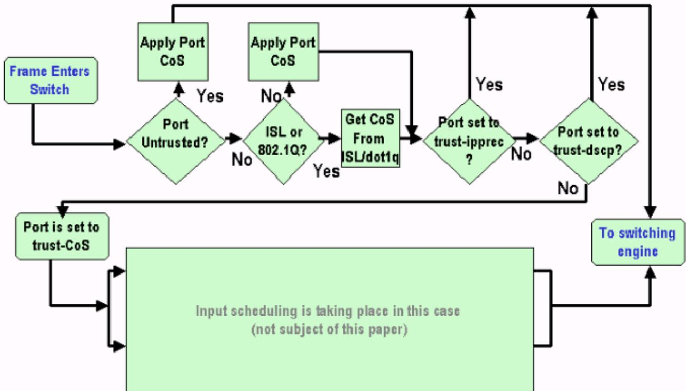
**注意：**如上面的流程图所示，每个帧将分配一个内部CoS（接收的CoS或默认端口CoS），包括不承载任何实际CoS的无标记帧。此内部CoS和接收的DSCP写入特殊数据包报头（称为数据总线报头），并通过数据总线发送到交换引擎。这种情况发生在入口线卡上，此时尚不清楚此内部CoS是否将携带到入口ASIC并插入到出站帧中。这取决于PFC的功能，下一节将进一步介绍。
