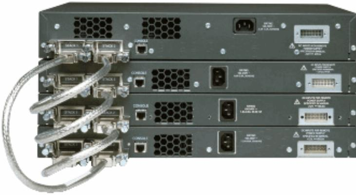
这用于连接到 Catalyst 3750 交换机后面板上的 StackWise 端口。Cisco StackWise 技术采用专用的连接器和电缆。
