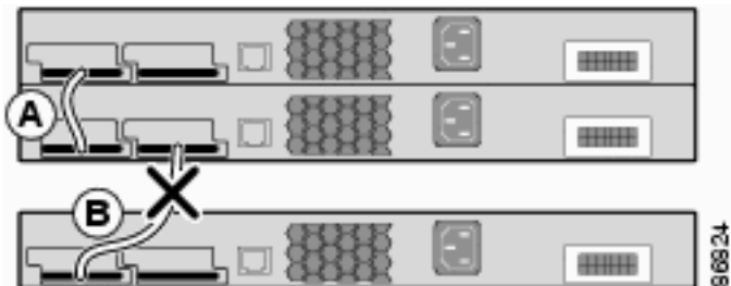
单个位置的电缆发生故障，堆栈已分区
