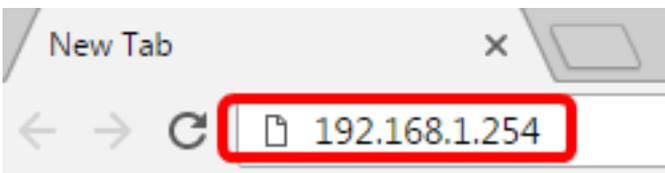
**注意：**为了正确连接，请确保您的计算机与交换机在同一子网中具有IP地址。在本例中，计算机的IP地址为192.168.1.100，子网掩码为255.255.255.0。
