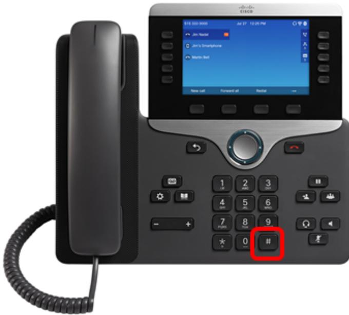
步骤3.静音指示灯关闭后，松开井号键，然后按1、2、3、4、5、6、7、8、9、\*、0、#sequentially。您应在不到五秒内完成按上述所有键，否则重置过程将不会成功。
