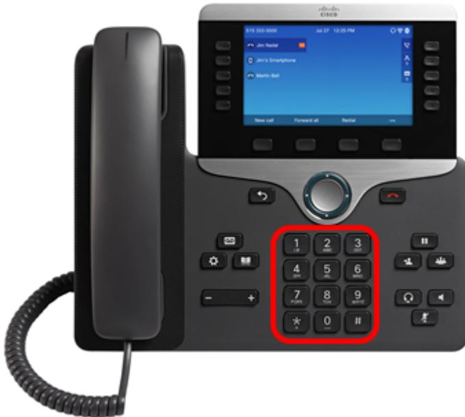
**注意：**按下键盘后，静音按
