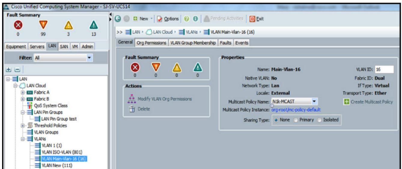
3. 对于N1KV，确认VLAN 16上已启用IGMP监听（默认启用）。要支持基本的L2组播，不必对N1KV进行配置。
