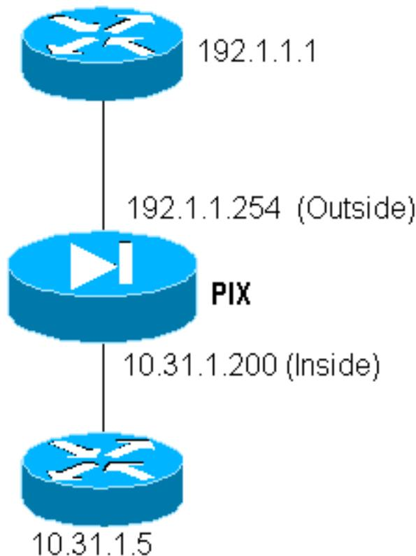
要通过TFTP将文件从外部路由器(192.1.1.1)复制到内部路由器(10.31.1.5)，请添加虚拟Telnet以打开TFTP流程通道：
