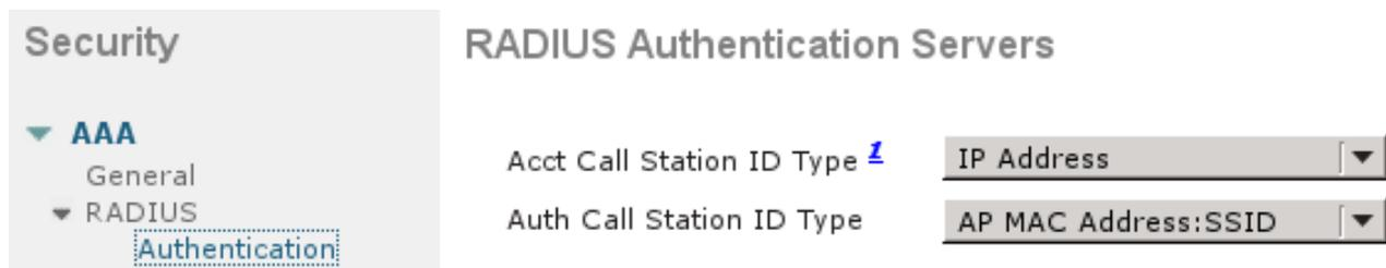
2. 在WLAN选项卡下，请创建无线局域网(WLAN)访客并且配置正确接口。设置Layer2安全对无与MAC过滤。在安全/验证、授权和统计(AAA)服务器中，请选择验证和核算的ISE IP地址。在高级选项卡。 ，请启用**AAA覆盖**并且设置网络准入控制(NAC)状态为RADIUS NAC (CoA支持)。
