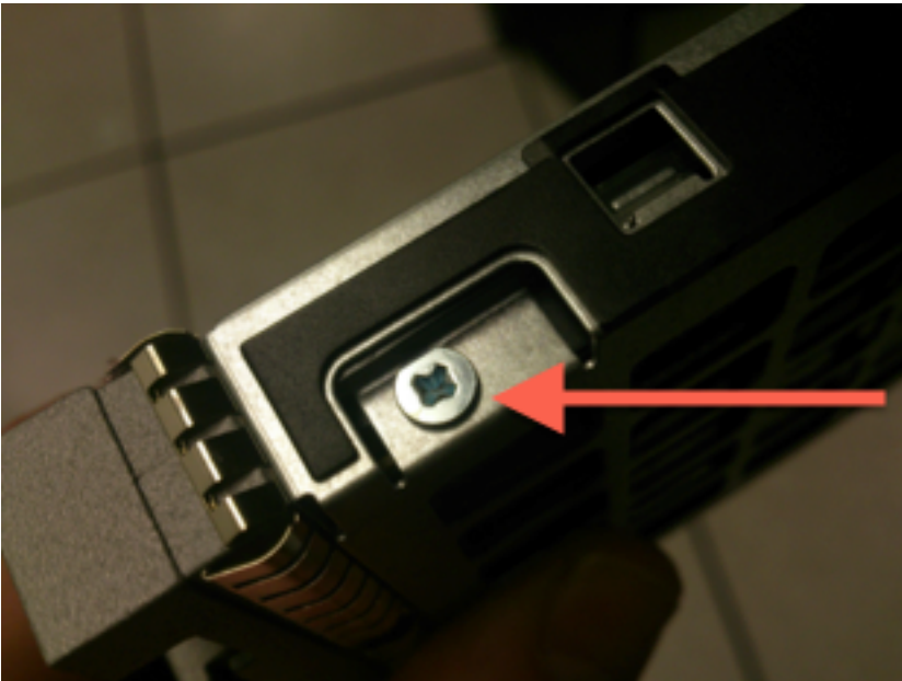
图：四个十字头螺钉将驱动器固定到滑板上：每边两个。
