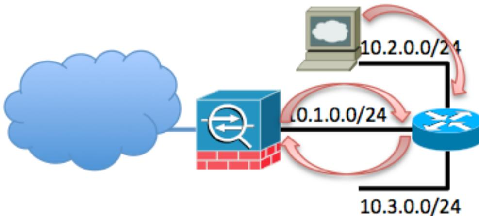
此循环发生，直到此数据包的TTL递减到0。请注意，ASA防火墙在处理数据包时不会默认递减TTL值。路由器在路由数据包时递减TTL。这可以无限期地防止此环路的出现，但此环路确实会增加ASA上的流量负载并导致CPU使用率激增。
