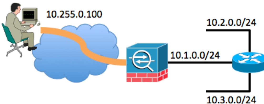
在本例中，远程访问客户端已分配IP地址10.255.0.100。本例中的ASA与路由器连接到同一内部网段。路由器还连接了两个额外的第3层网段。ASA和路由器的相关接口（路由）和VPN配置如示例所示。
