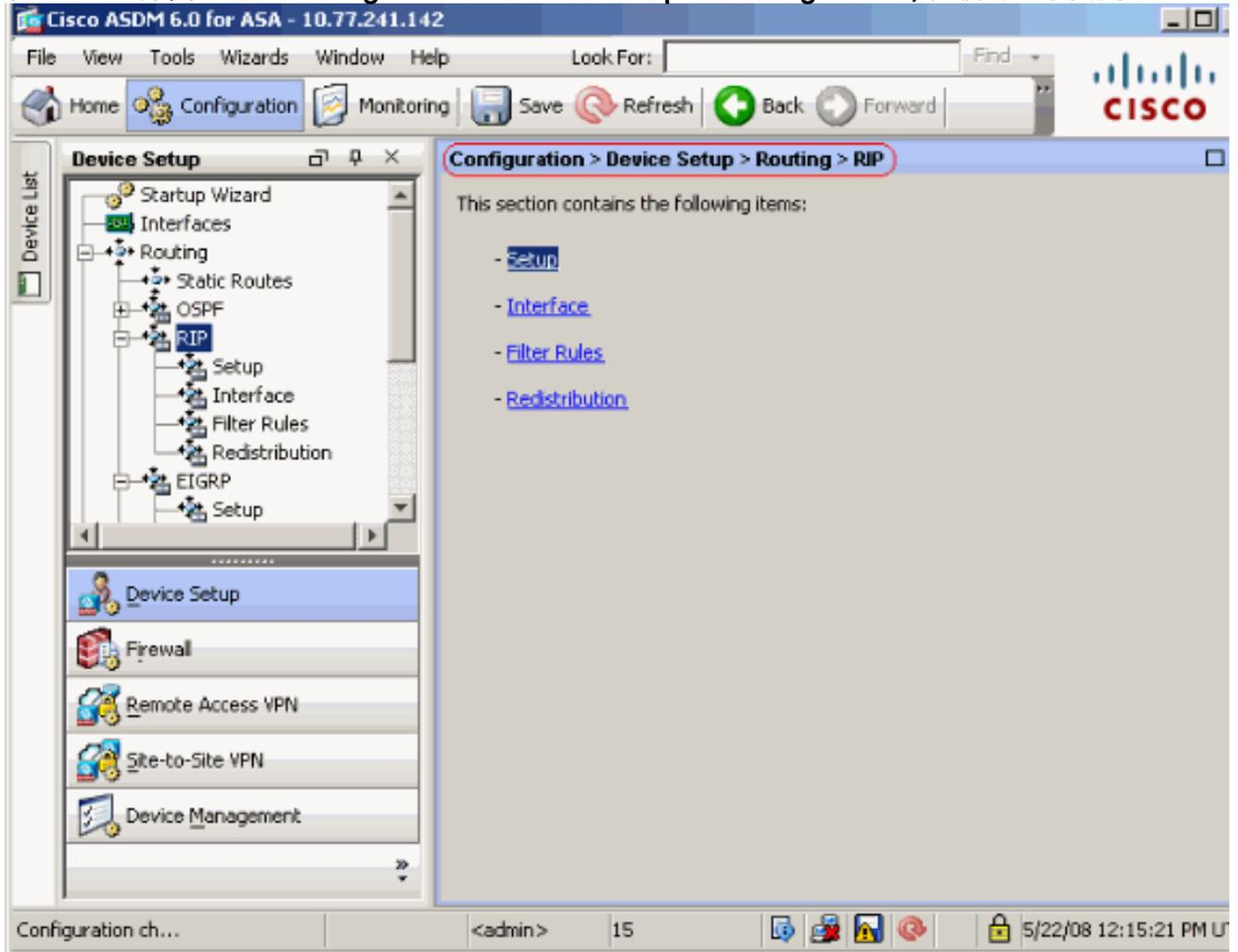
3. 选择 Configuration > Device Setup > Routing > RIP > Setup，以启用 RIP 路由（如图所示）。选中 Enable RIP routing 复选框。选中 Enable RIP version 复选框并选中 Version 2 单选按钮。在 Networks 选项卡下，添加网络 10.1.1.0。单击 Apply。
