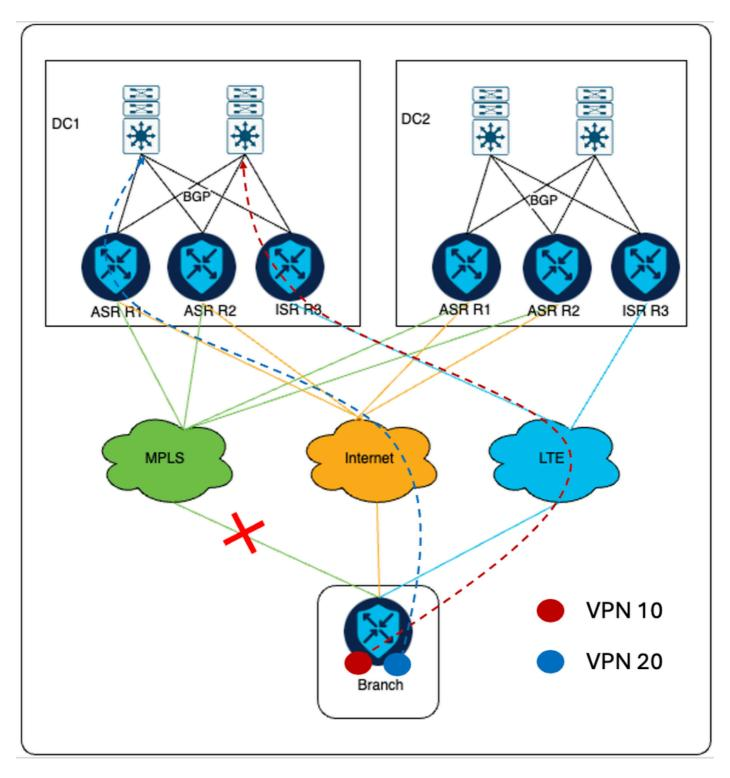
对于来自核心交换机的返回流量,对于VPN 10流量,将发送到ISR cEdge,因为通过ISR的AS-PATH长度比本地化策略部分中指定的ASR更短。同样,由于AS-PATH通过ASR比ISR更小,因此VPN 20流量会发送到ASR cEdge。
