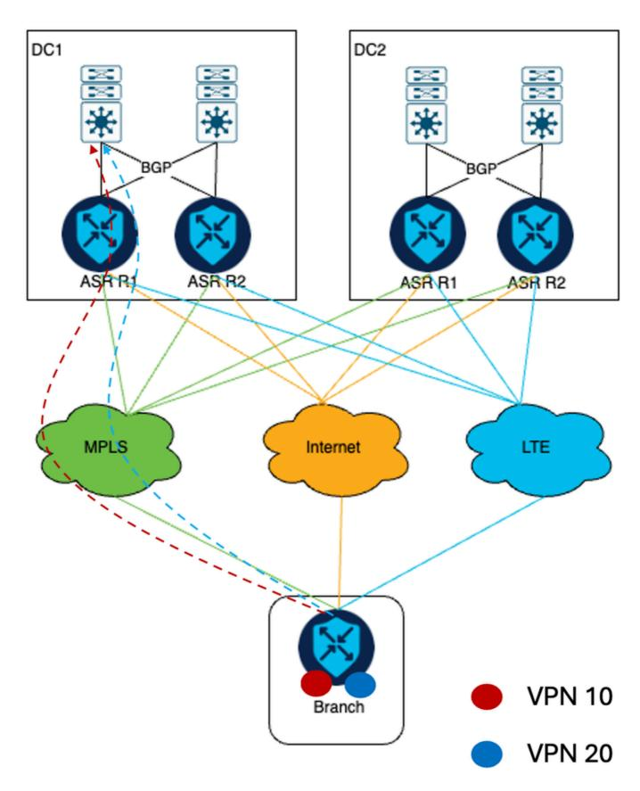
如果MPLS链路断开,VPN 10流量将转移到LTE传输,而VPN 20流量将转移到Internet传输。
