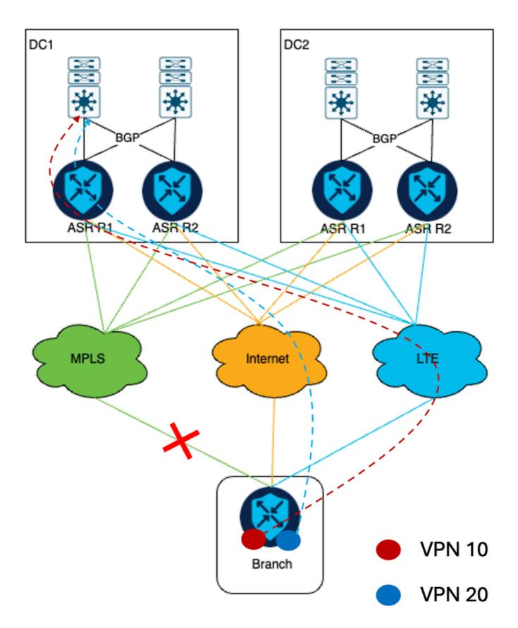
此场景中的技术难题源于客户网络部署的规模和特定要求。 考虑部署3000台SD-WAN路由器,这些路由器通过三种类型的传输建立IPSec隧道到数据中心路由器,因此ASR1002-HX主前端路由器上形成的IPSec隧道总数达到9000。但是,ASR1002-HX仅限于8000个IPSec隧道(来源:ASR1K数据表)。
