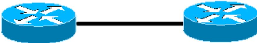
两个POS接口之间背靠背连接的两台路由器必须像上一个场景一样运行。您可以在任一路由器上立即看到故障，因为没有中间设备在SONET开销上运行或终止SONET级信号的任何部分。
