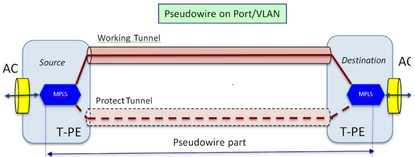
端到端服务由两个部分组成。连接电路(AC)部分和伪线部分。整个电路端到端在Cisco传输控制器(CTC)中仍称为伪线，但请记住此处展示的两个不同部分用于以下故障排除。
