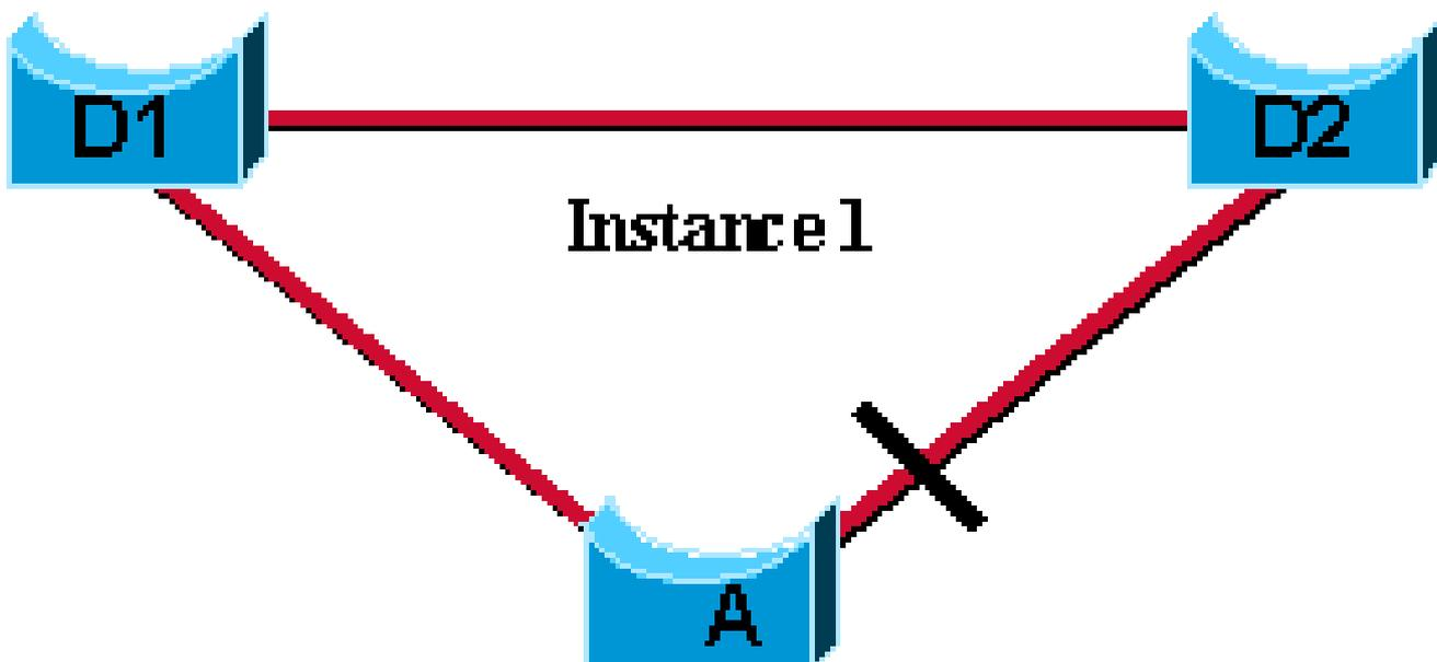
由于手动修剪，因此在阻塞端口上只允许使用 VLAN 20，这就是连接断开的原因。为了实现负载均衡，网络管理员必须将 VLAN 10 和 20 映射到两个不同的实例。
