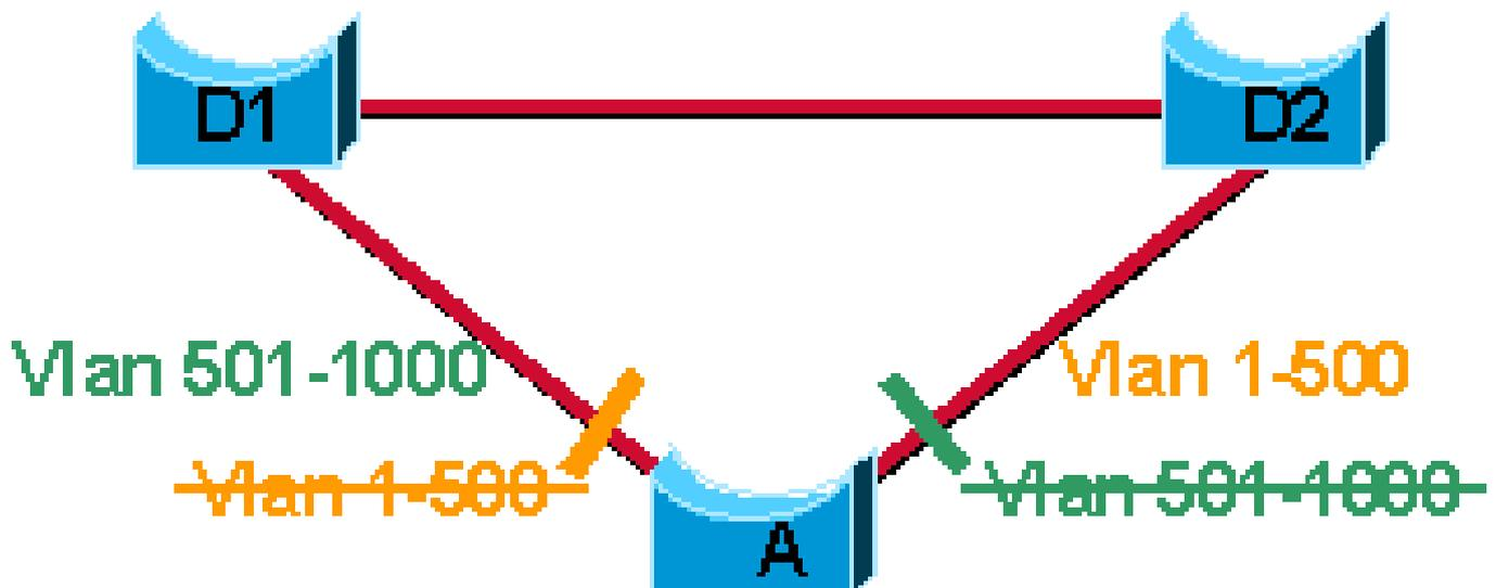
具有1000个VLAN的接入交换机A与交换机D1和D2冗余连接
