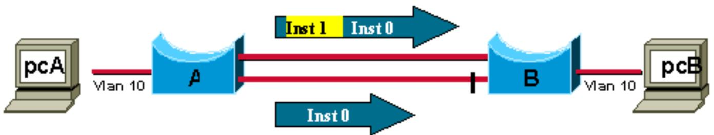
交换机 B 从交换机 A 接收实例 0 的两个 BPDU ( 每个端口一个 BPDU )。很明显，交换机 B 必须阻塞其中一个端口，以避免循环。
