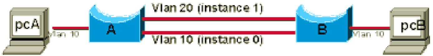
此配置将导致 pcA 无法向 pcB 发送帧。show命令表明交换机B要阻塞VLAN 10中指向交换机A的链路，如下图所示：
