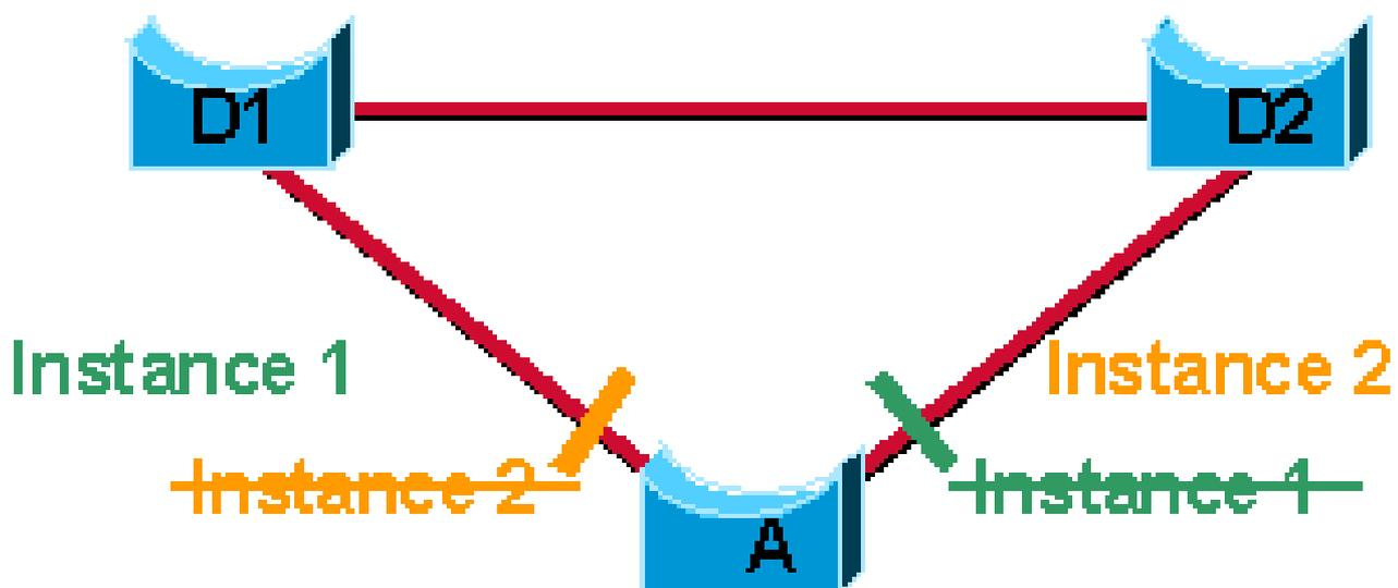
将1000个VLAN的一半映射到不同的生成树实例
