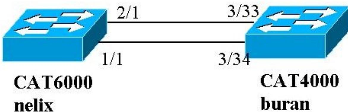
在本示例中，我们按上图所示使用两个千兆以太网端口在 Catalyst 4000 和 Catalyst 6000 系列交换机之间配置 LACP 汇聚链路。
