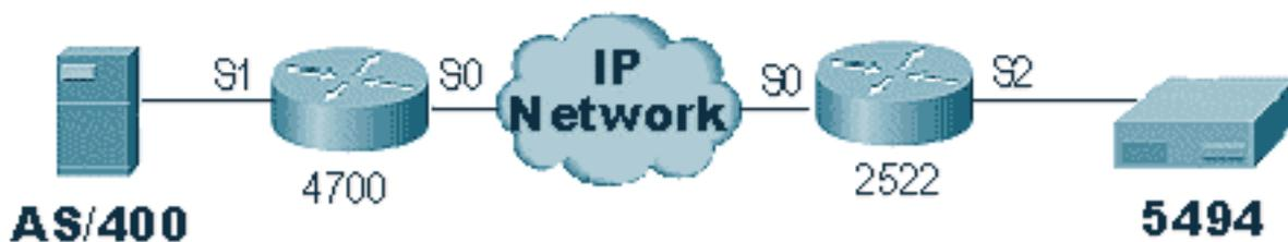
此方案具有将5494连接到AS/400的STUN基本设置。使用任何STUN设置要检验的第一件事是对等体是在路由器中设置的。要确定这一点，请使用show stun peer命令。它提供有关对等体状态和发送/接收的数据包的信息。输出示例如下所示：
