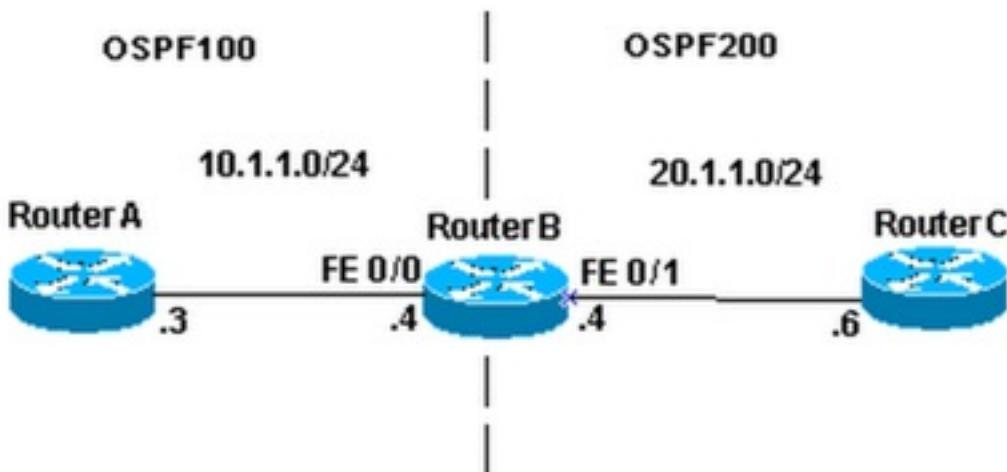
在客户原先的网络设计中，将路由器A发布的路由cost值为1，而路由器C发布的metric值被人为增加cost为200。客户认为根据OSPF协议的选路比较原则，在路由器B的路由表中应该优先选择metric最小的路由，因而会选择路由器A的接口作为该路由的下一跳，而路由器C发布的路由作为本条路由的备份。
