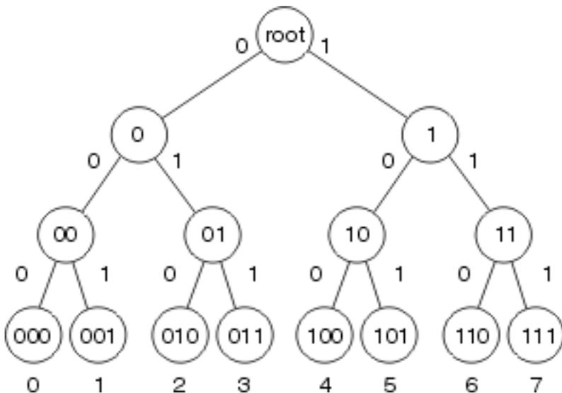
在快速交换中，可达性信息通过二分树上存在的节点表示为信息包的目的地。每个目的地的MAC报头和出局接口均作为树内节点的部分信息存储。二分树实际上可以有 32 个级别（上图中的树出于示例目的经过了很大程度的简化）。
