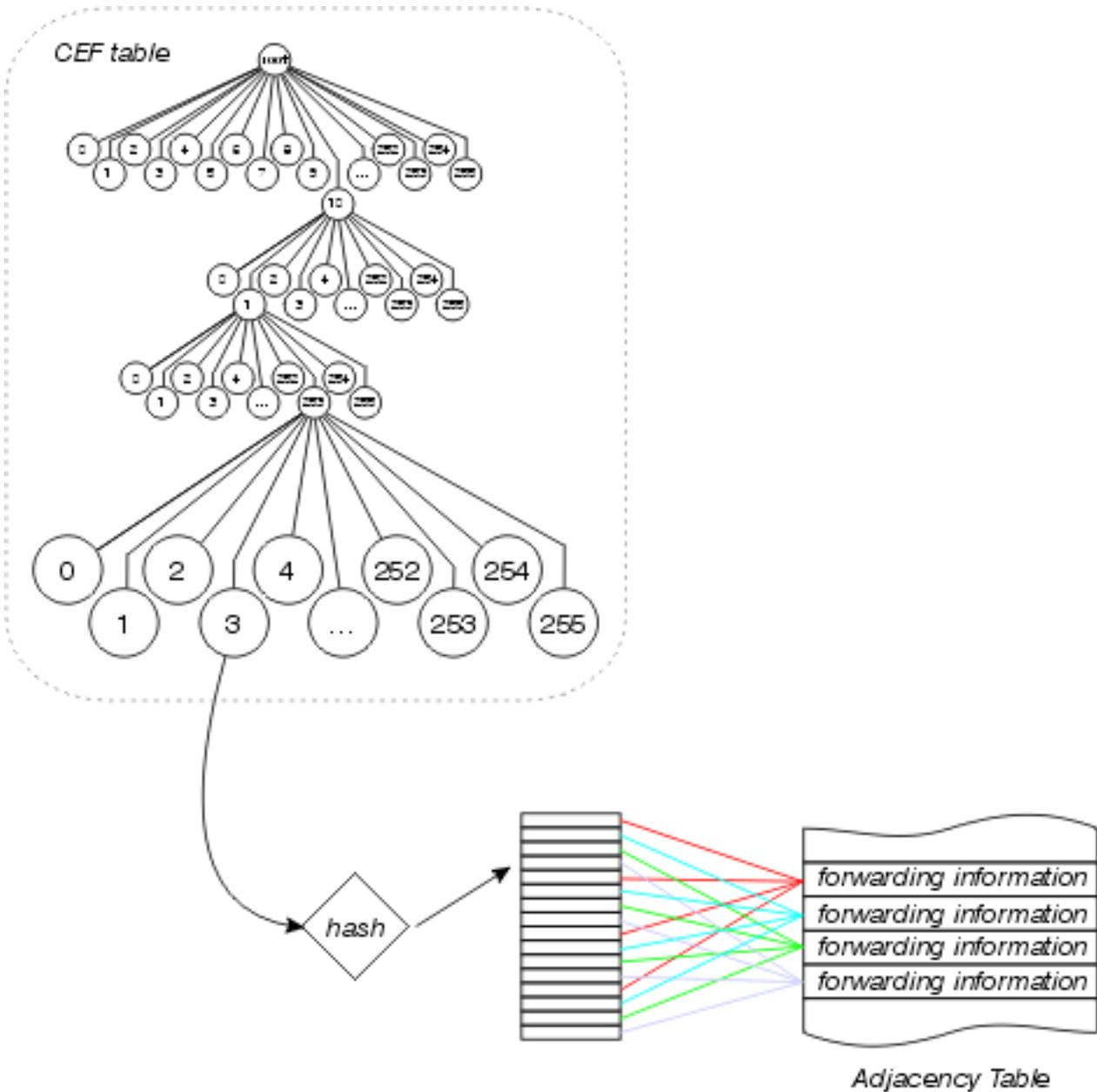
Cisco快速转发表指向此加载共享表，其中包含指向可用并行路径的各种邻接表条目的指针。源地址和目的地址都通过Hash算法来确定每个信息包使用哪个负载分摊表条目。可配置每数据包负载共享
