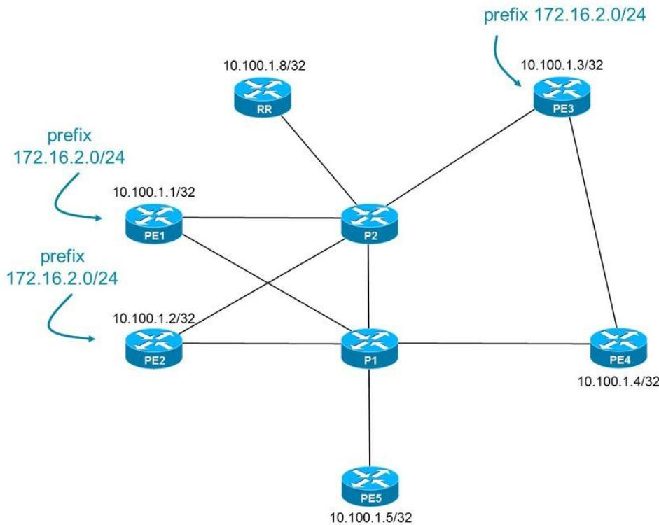
路由器PE1、PE2和PE3通告前缀172.16.2.0/24。如果链路的所有IGP开销相同，则RR将看到来自PE1、PE2和PE3的路径，其IGP开销为2。最后，RR选择来自PE1的路径，因为它的BGP路由器ID更低。这是BGP最佳路径选择算法中的步骤11。结果是，所有PE路由器（包括PE4）都会选择PE1作为前缀172.16.2.0/24的出口PE路由器。从PE4的角度来看，到任何出口PE路由器的较短的IGP路径是到PE3的路径，IGP开销为1。IGP开销到任何其他PE路由器2.对于许多网络，以尽可能短的方式通过中转网络传输流量这一事实非常重要。这称为火薯路由。
