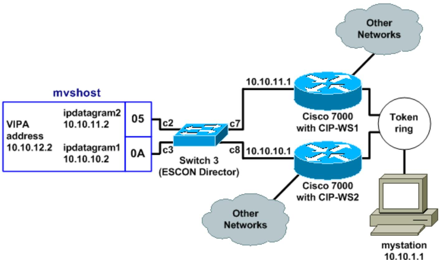
路由信息协议(RIP)收敛时间（使用默认设置）可长达六分钟。例如，如果带CIP-WS2的Cisco 7000在该拓扑中发生故障，则经过该拓扑的流量可能需要6分钟时间才能开始通过带CIP-WS1的Cisco 7000。为了缩短收敛时间，可以更改路由器上的RIP计时器。
