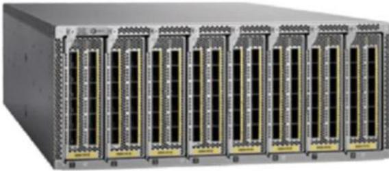
Cisco Nexus 5696Q 扩展模块提供与机箱底座之间的多个接口选项。Cisco Nexus 5696Q 支持 40/10 千兆以太网 LEM（使用 QSFP+ 光纤）。每个 40 千兆以太网扩展模块（图 7）提供 12 个 40 千兆以太网端口和 FCoE 端口（使用一个 QSFP 接口），或 48 个 10 Gbps 端口（使用分支电缆）。安装了八个扩展模块后，Cisco Nexus 5696Q 可使用分支电缆提供 96 个 QSFP 端口或 384 个万兆以太网 (SFP+) 端口。所有扩展模块都可热插拔。
