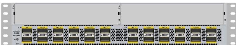
Cisco Nexus 5648Q 具有两个扩展插槽，使用一个热插拔 GEM 支持另外 24 个 40 千兆以太网端口，如图 2 所示。Cisco Nexus 5624Q 和 5648Q 可以通用同一个扩展模块。
