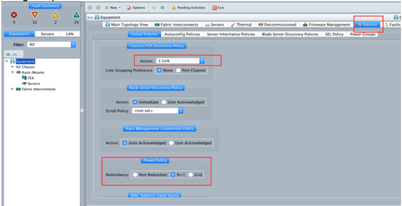
Na guia Chassis/FEX discover policy (Política de descoberta de chassi/FEX), aqui você deve selecionar o número de links conectados entre um par individual de IOM e interconexão de estrutura. Por exemplo, no desenho exibido anteriormente, cada IOM tinha uma conexão com a interconexão de estrutura associada. Assim, é criada uma política de **1 link**. Essa política é essencialmente apenas especificar quantas conexões precisam estar presentes para que um chassi seja descoberto.
