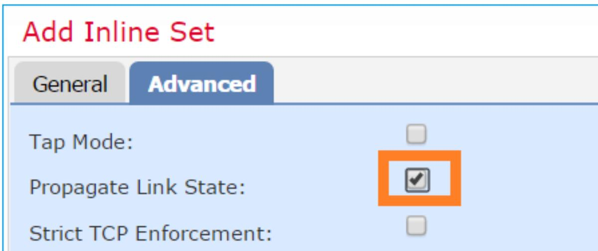
A propagação de estado do link ativa automaticamente a segunda interface no par de interface em linha quando uma das interfaces no conjunto em linha fica inativa.
