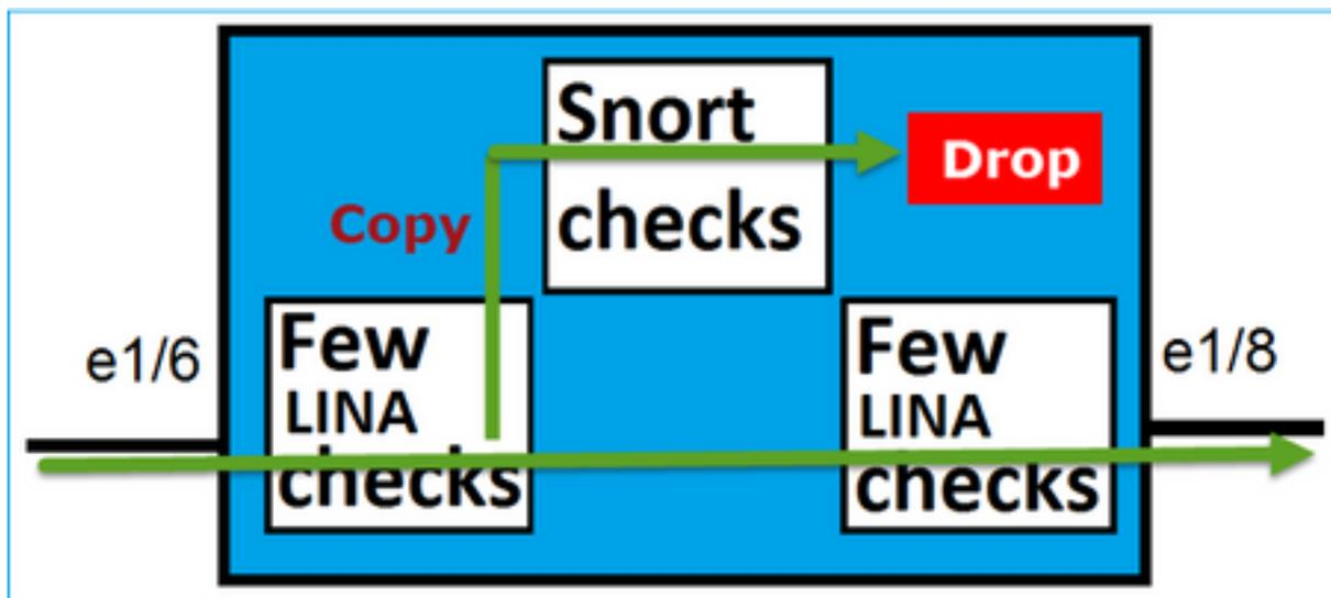
O par em linha com modo de toque não descarta o tráfego em trânsito. Com o rastreamento de um pacote, ele confirma isso:
