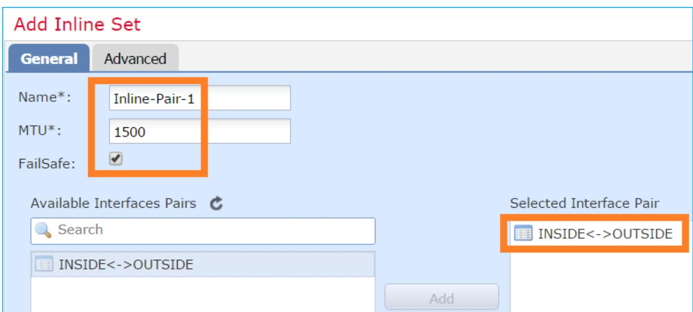
**Note:** Failsafe permite que o tráfego passe pelo par em linha não inspecionado caso os buffers da interface estejam cheios (normalmente visto quando o dispositivo está sobrecarregado ou o mecanismo Snort está sobrecarregado). O tamanho do buffer da interface é alocado dinamicamente.
