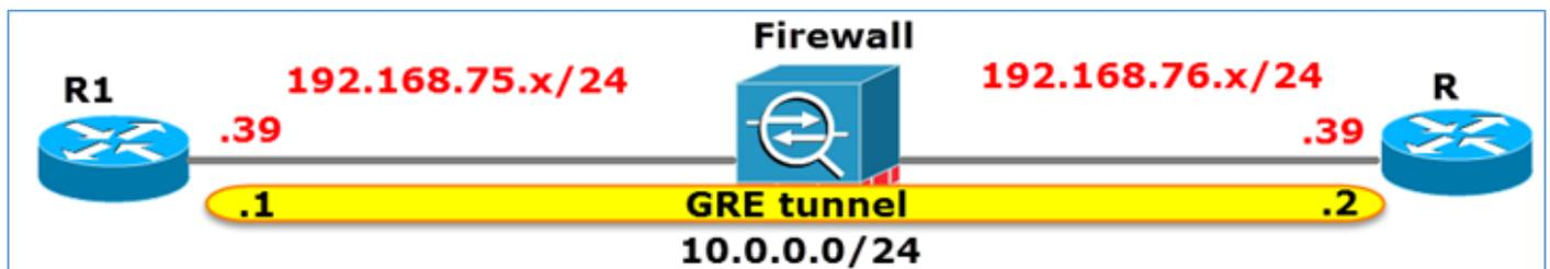
Quando você faz ping de R1 para R2 com o uso de um túnel GRE, o tráfego passa pelo Firewall com a aparência mostrada na imagem.
