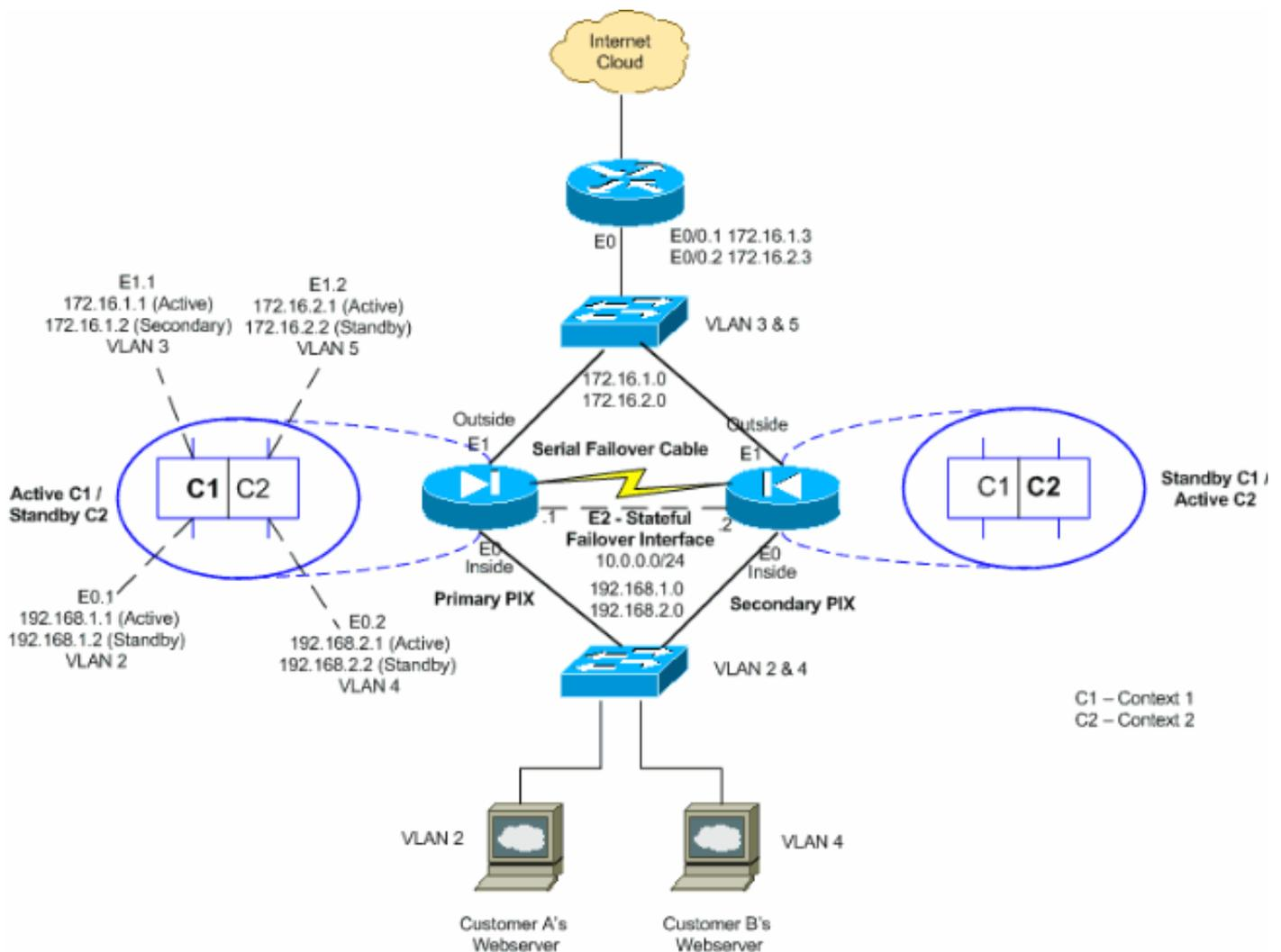
Siga estas etapas para configurar o Failover Ativo/Ativo usando um cabo serial como o link de failover. Os comandos nesta tarefa são inseridos na unidade primária no par de failover. A unidade primária é a unidade que tem a extremidade do cabo "Primário" conectada a ela. Para dispositivos no modo de contexto múltiplo, os comandos são inseridos no espaço de execução do sistema, a menos que observado de outra forma.
