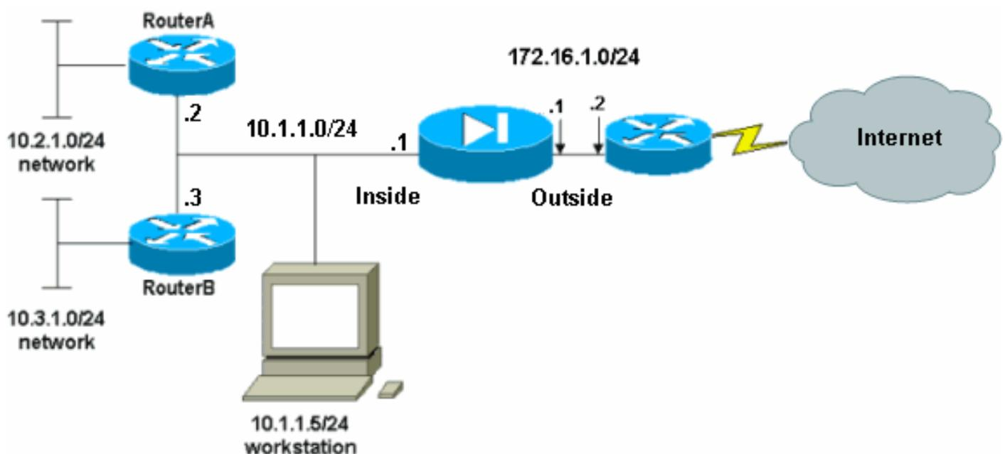
O gateway padrão dos hosts na rede 10.1.1.0 aponta para o RoteadorA. Uma rota padrão no roteadorB é adicionada que aponte ao roteadorA. O roteador A tem uma rota padrão que aponta para a interface dentro do PIX.
