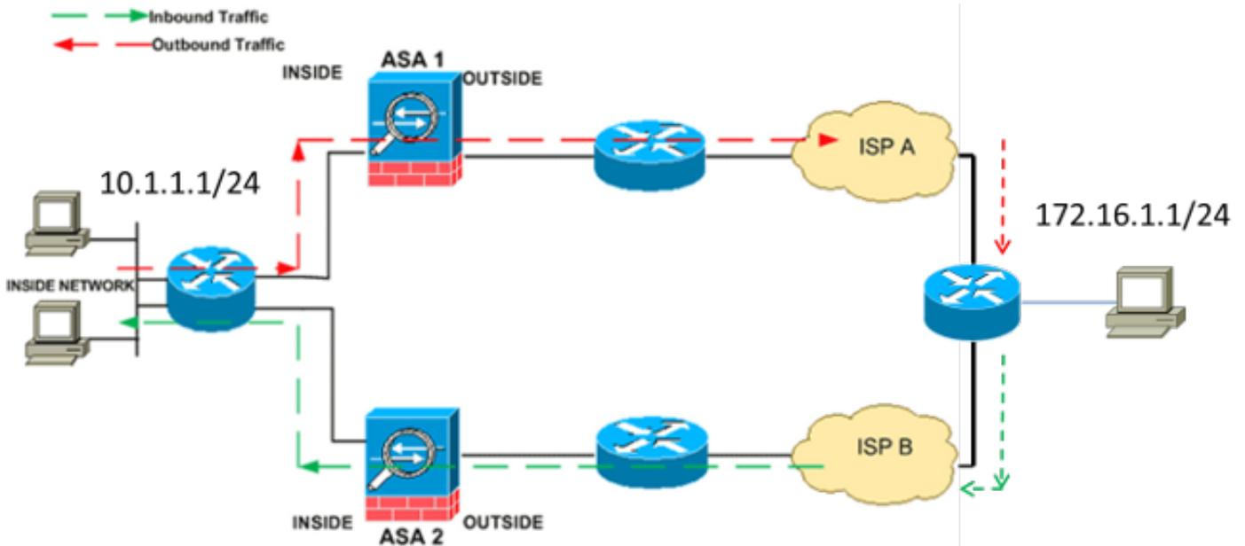
**Note:** O recurso de desvio de estado TCP é desativado por padrão no Cisco ASA 5500 Series. Além disso, a configuração de desvio de estado do TCP pode causar um alto número de conexões se não for implementada corretamente.
