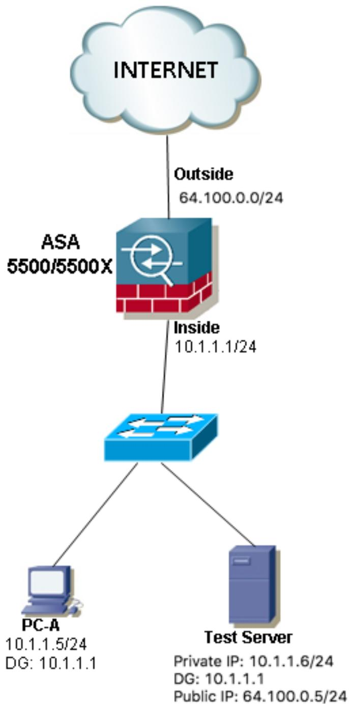
**Exemplo 3.** Os hosts origem e destino PC-A e Test Server estão conectados à interface interna do ASA, mas atrás de outro dispositivo da camada 3 (pode ser um roteador ou um switch multcamada).
