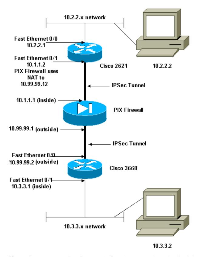
**Observação:** os esquemas de endereçamento IP usados nesta configuração não são legalmente roteáveis na Internet. Esses são endereços <u>RFC 1918</u> que foram usados em um ambiente de laboratório.
