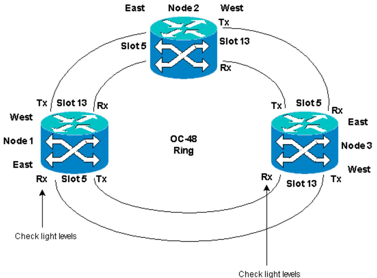
Quando você reconecta fibras a nós adjacentes, é recomendável primeiro conectar somente as fibras Tx e verificar os níveis de luz antes de conectar as fibras Rx. Os níveis de Rx podem ser encontrados na seção Referência de Placa do [Guia de Referência do Cisco ONS 15454, Versão 3.4](#).
