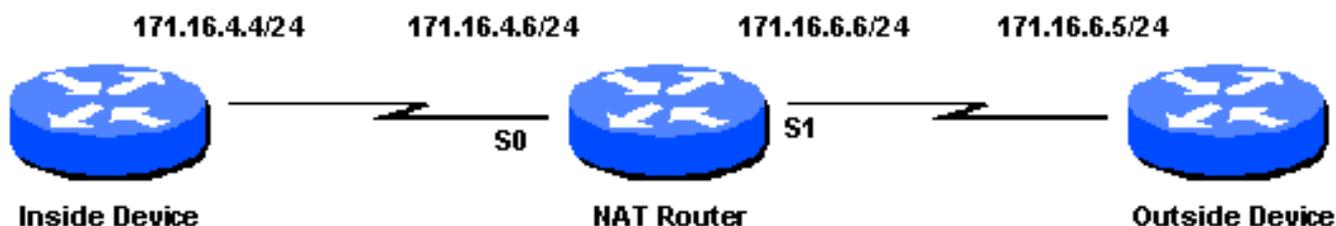
Neste exemplo de configuração, o dispositivo interno tem uma rota padrão do roteador NAT. O dispositivo externo tem uma rota estática para um endereço para o qual o dispositivo interno é convertido. O roteador NAT possui essa configuração NAT:
