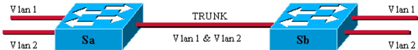
Neste diagrama, o link físico exclusivo entre os dois switches é capaz de transportar tráfego para qualquer VLAN. Para conseguir isso, cada quadro enviado no link é marcado por Sa para que Sb saiba a qual VLAN pertence. O 802.1Q usa um mecanismo interno de rotulação. Interna significa que uma marca é inserida dentro do quadro, como mostrado abaixo.
