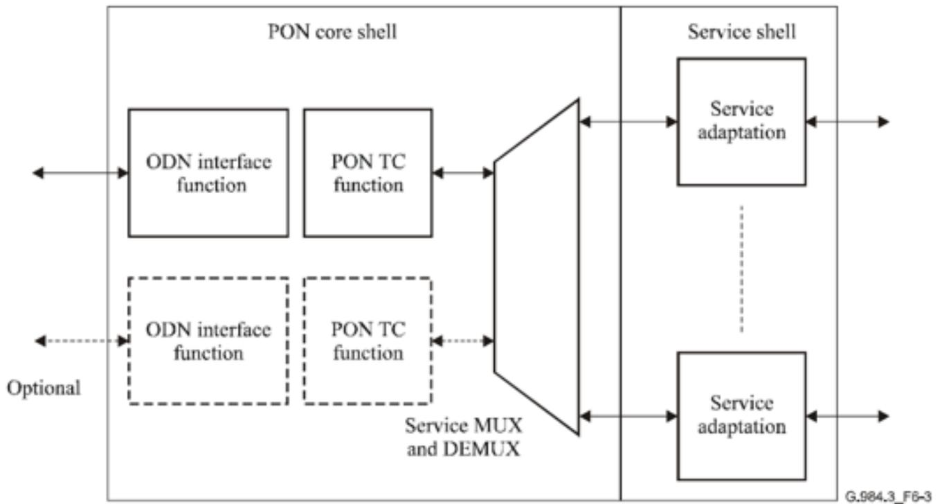
기능 블록은 OLT와 유사합니다. ONU/OLT가 단일 PON 인터페이스로 동작하는 경우(보호 목적상 최대 2개), 교차 연결 기능은 생략된다. 이 기능 대신 MUX 및 DEMUX 서비스가 이제 트래픽을 담당합니다.
