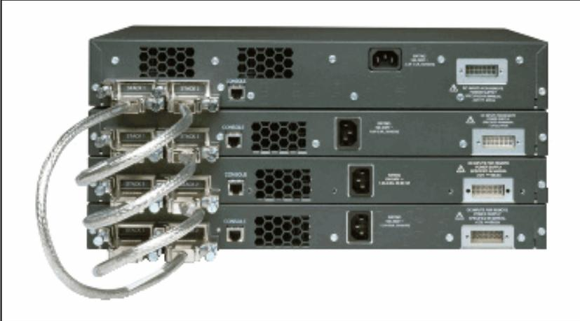
이는 Catalyst 3750 스위치의 후면 패널에 있는 StackWise 포트에 연결하는 데 사용됩니다. Cisco StackWise 기술은 전용 커넥터와 케이블을 사용합니다.
