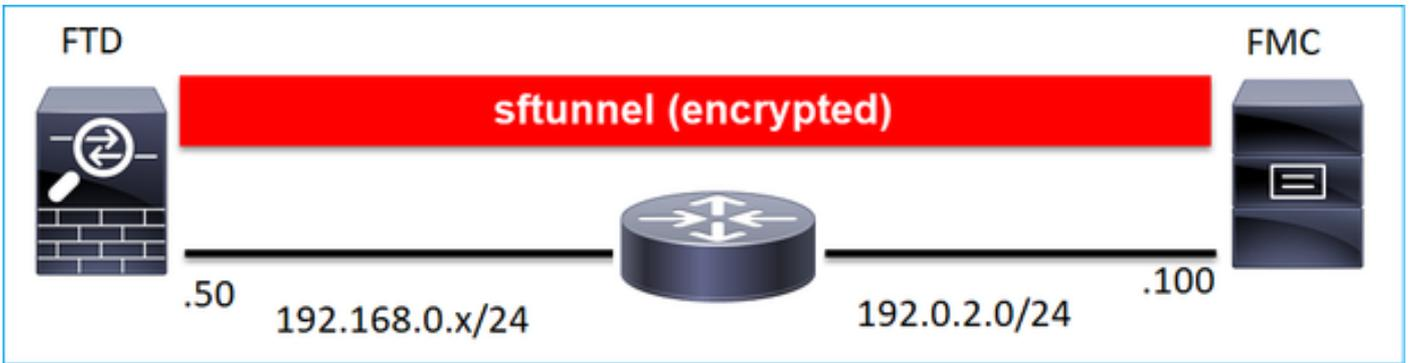
참고: sftunnel은 FTD 자체도 통과할 수 있습니다. 이 설계는 권장하지 않습니다. 그 이유는 FTD 데이터 플레인 문제가 FTD와 FMC 간의 통신을 방해할 수 있기 때문입니다.
