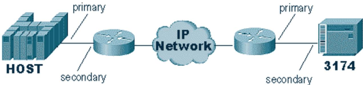
이러한 명령은 STUN 설정의 "역할"을 정의합니다. 위 다이어그램에 있는 호스트의 경우 라우터가 **primary**로 설정되어 있으며, 이는 호스트가 세션을 시작하는 호스트임을 의미합니다. 이렇게 하면 3174가 **보조**됩니다. STUN Basic을 사용할 경우, 세션을 시작할 사람을 알 필요가 없으므로 역할을 정의할 필요가 없습니다. 그러나 로컬 승인에는 회선 자체에 대한 세부 정보가 필요하고 역할을 정의하면 라우터가 세션 시작 흐름을 알 수 있습니다. 이 플로우를 로컬 승인으로 이동하기 전에 확인해야 합니다.
